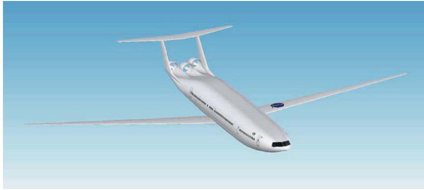
Fig. 6. The MIT N+3 'Double Bubble' aircraft (Greitzer et al., 2011).
